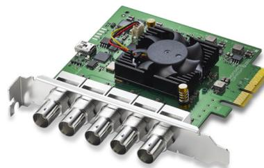
El modelo DeckLink Duo 2 es una tarjeta PCIe de captura y reproducción con cuatro conexiones SDI 3G independientes que permite procesar formatos en definiciones SD o HD con una resolución máxima de 1080p60. Brinda la flexibilidad de contar con el equivalente a cuatro unidades en un solo dispositivo y gracias a que es totalmente personalizable, resulta ideal para sistemas de difusión, servidores de cartelera digital y plataformas de captura y reproducción en tiempo real con múltiples canales.
